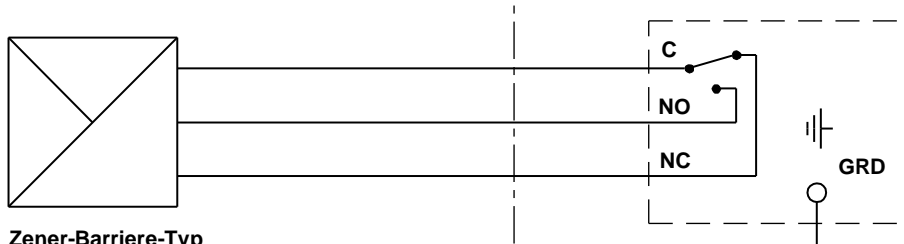
Bild 6: Betreiben von Druckschaltern in eigensicheren Bereichen
