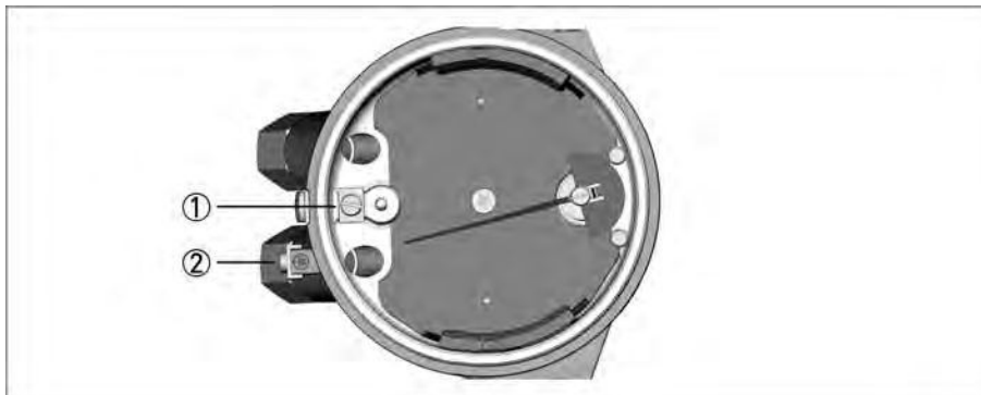
Abbildung 4-15: Erdungsanschlüsse
